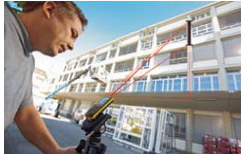
Indirekte Höhenmessung: Fensterhöhen mittels Pythagorasfunktion bestimmen.
