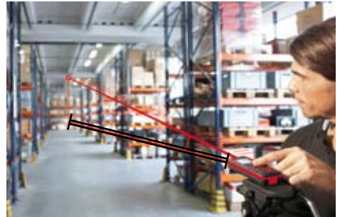
Smart Horizontal Mode™ – Distanzen absolut horizontal messen, auch über Hindernisse hinweg.
